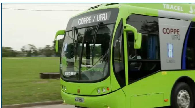
Figura 15 – Protótipo de ônibus a H<sub>2</sub> COPPE/UFRJ. Fonte: COPPE/UFRJ (2010).
